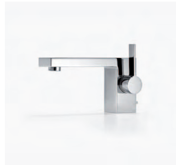
33 500 985 / 33 521 985 Waschtisch-Einhandbatterie mit/ohne Ablaufgarnitur, Ausladung 155 mm Wastafel eenhandelmengkraan met/zonder afvoergarnituur, sprong 155 mm Mitigeur monocommande de lavabo avec/sans garniture d'écoulement, saillie 155 mm [7 l/min.]
