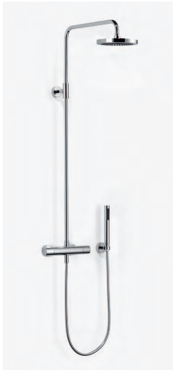
34 457 979 Brause-Thermostat für Wandmontage 1/2" mit Standbrause, Ø 220 mm Opbouw douchethermostaat voor wandmontage 1/2" met regendouche, Ø 220 mm Mitigeur thermostatique de douche pour montage mural 1/2" avec crosse à angle droit et douchette à main, Ø 220 mm [7,6 l/min.]**
